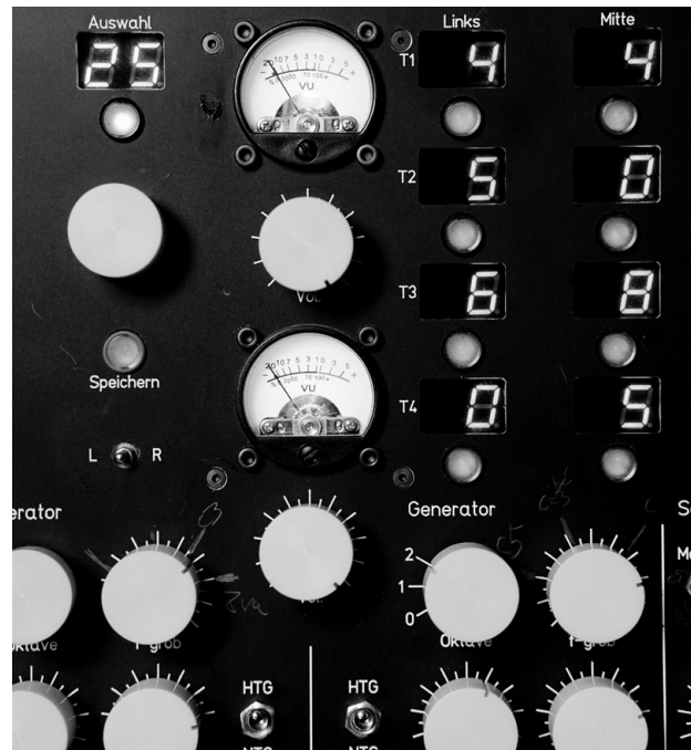
Subharmonischer Generator mit Haupt- und Nebengenerator
